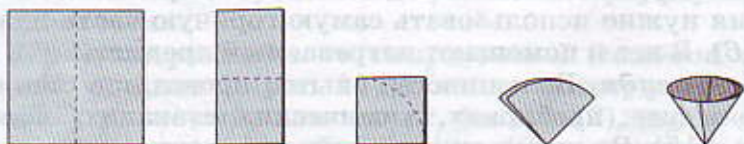
Рис. 118. Последовательность изготовления бумажного фильтра
